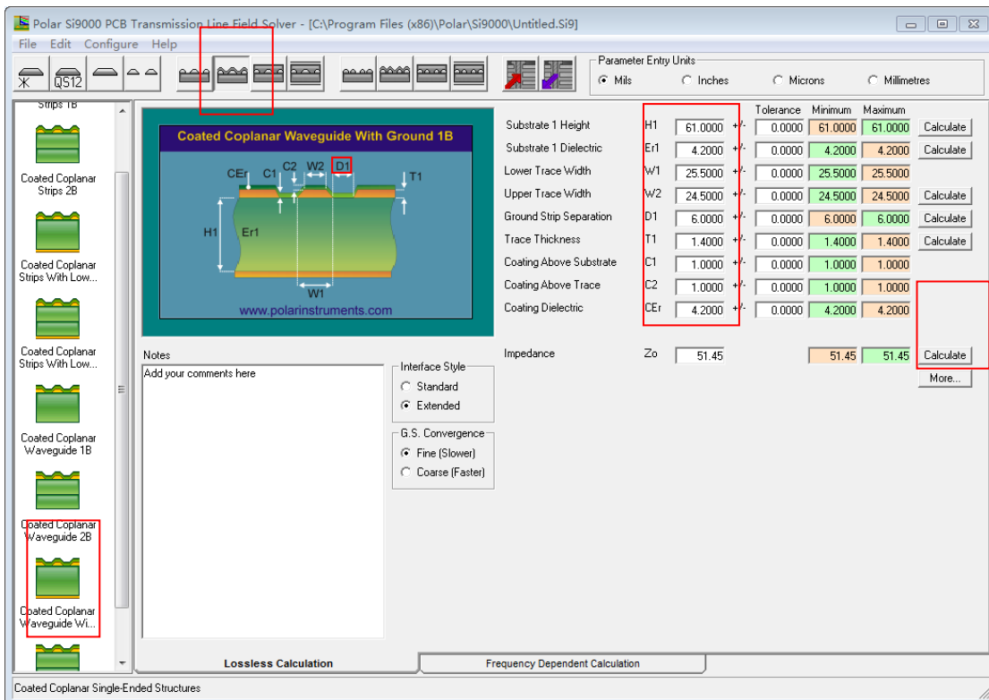
图 8.3.3 两层板（1.6mm）走线特征阻抗计算图
