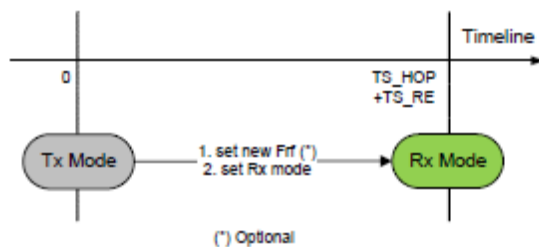
图 19 Tx 模式切换至 Rx 模式的周转时间
