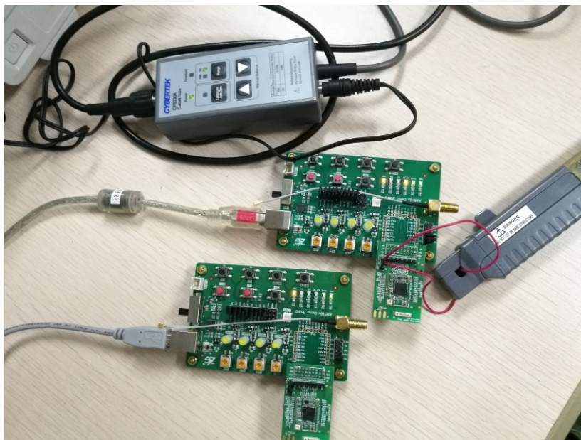
图 2.2 用电流钳、示波器测量输入电流（1）
