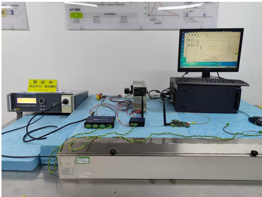
图 6 EFT/B 试验配置
