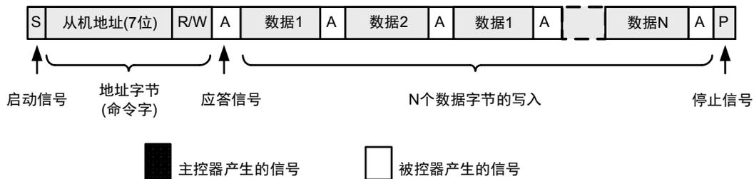
图 3.1 主机发送数据图示
