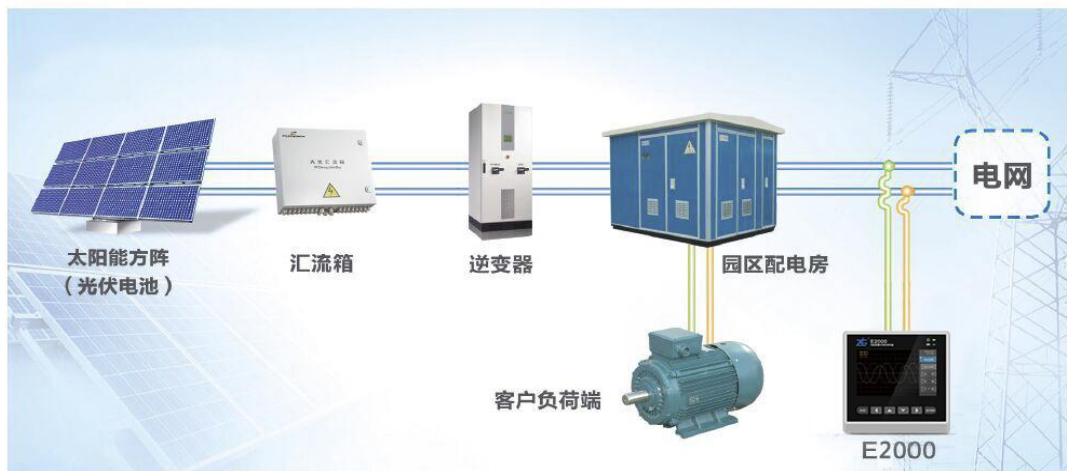
图 1 E2000 电能质量在线装置在并网环节的应用示意图
