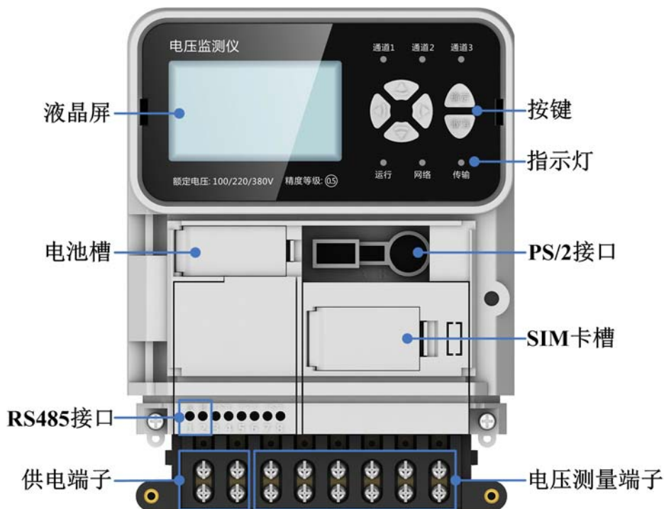
图 2-1 电压监测仪结构
