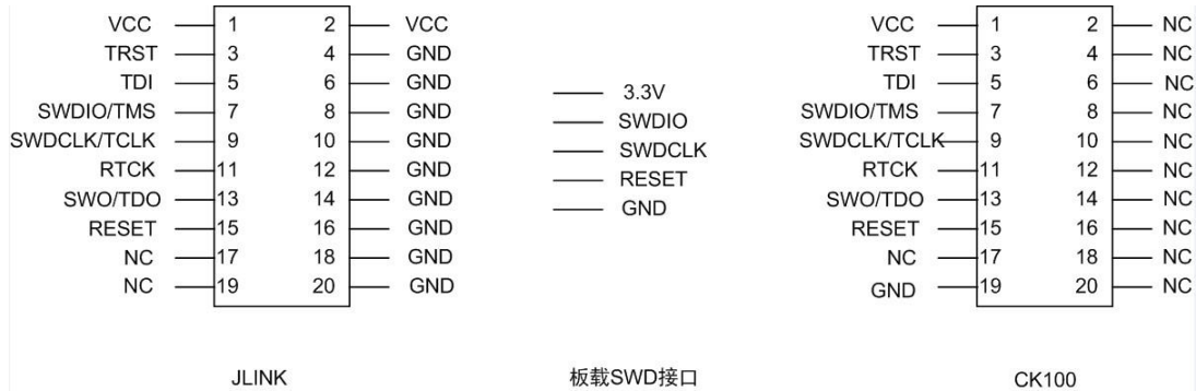
图 4.1 仿真器与板载调试口连接关系图
