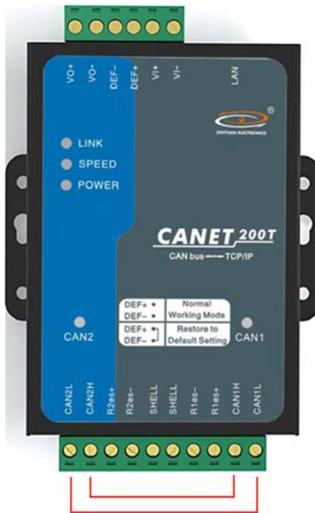
图 6.3 短接 CAN1 与 CAN2 通道
