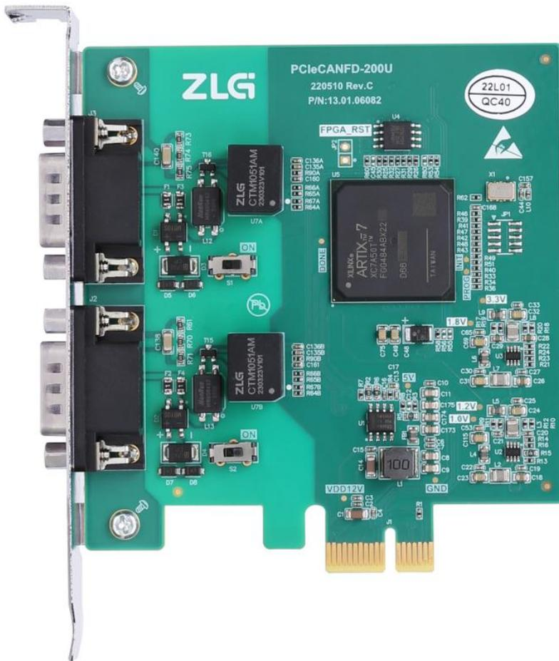
图 1.1 PCIeCANFD-200U 外观图
