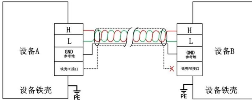
图 2.5 三芯单层屏蔽电缆接线示意图
