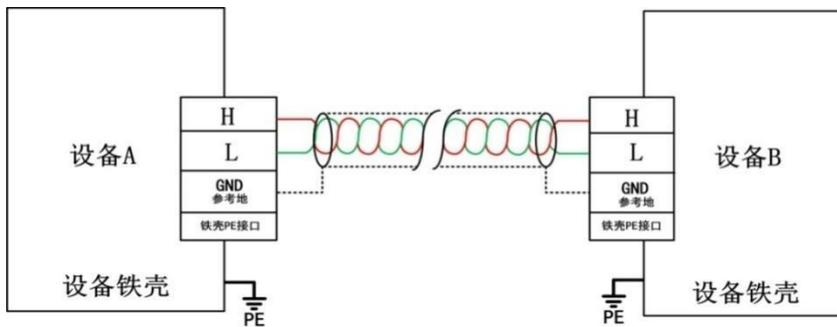
图 2.3 双芯单层屏蔽电缆接线示意图
