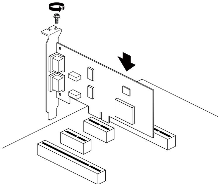
图 2.4.1 PCIe-200U 系列 CAN 接口卡拔插示意图
