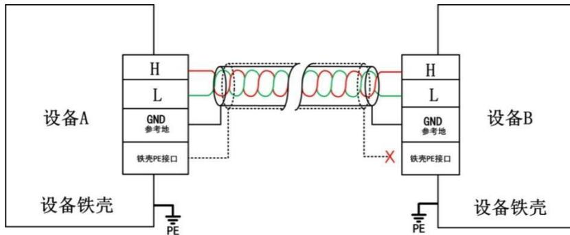
图 2.4 双芯双层屏蔽电缆接线示意图
