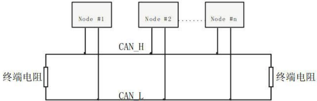
图 2.2 CAN-bus 网络直线拓扑结构
