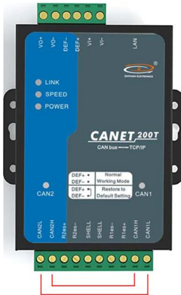
图 6.3 短接 CAN1 与 CAN2 通道
