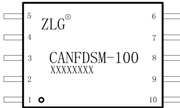
图 2.2 顶视图（引脚功能描述）
