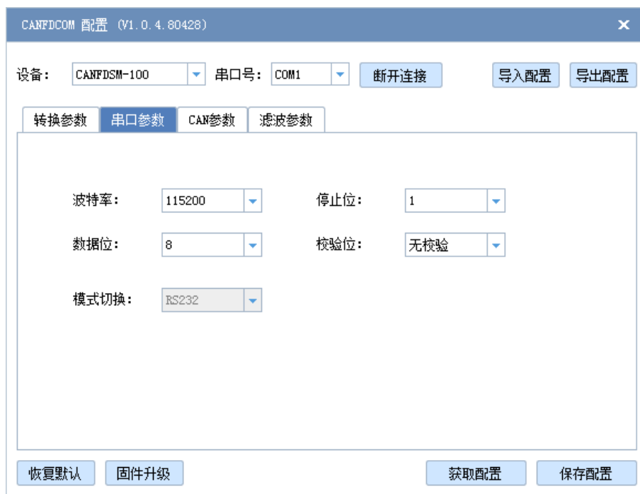
图 5.3 串口参数设置
