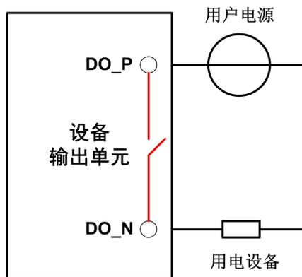
图 3.2 DO 网络连接示意图
