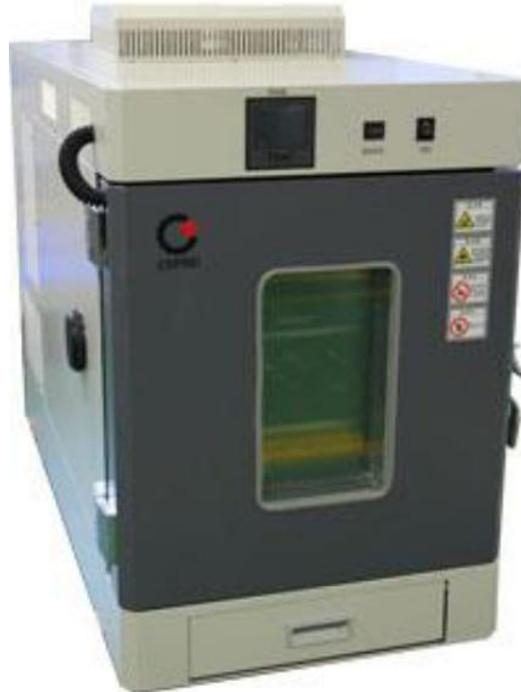
图 1 CEEC-M64H-65 桌面型高低温湿热试验箱
