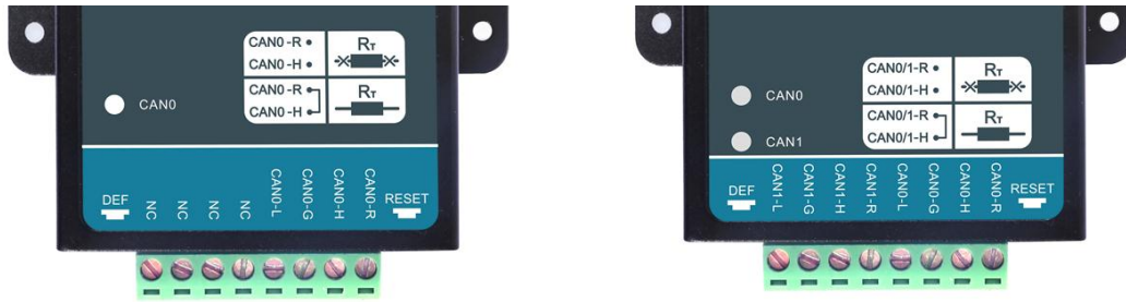
图 2.5 CANET-E-U 和 CANET-2E-U 的 CAN 口外观图
